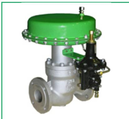
Регуляторы давления «после себя» РД 510 представляют собой устройства с пилотным приводом. Работают от энергии потока рабочей среды и предназначены для поддержания заданного, пониженного, давления рабочей среды в трубопроводе, емкости после регулятора.
