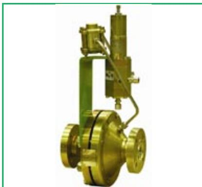
Регулятор давления РД 622 предназначен для поддержания заданного значения давления рабочей среды в трубопроводе перед регулятором. Регулятор давления РД 622 является стационарным изделием. Регуляторы давления тип РД 622 представляют собой устройства осевого типа с пилотным управлением.
