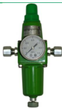
Редуктор давления с фильтром РДФ 300 предназначен для очистки воздуха от механических примесей, сбора конденсата, регулирования и автоматического поддержания заданного уровня выходного давления для питания пневматических приборов. Кроме воздуха могут применяться другие газы, не влияющие на работоспособность нитрильных резин.
